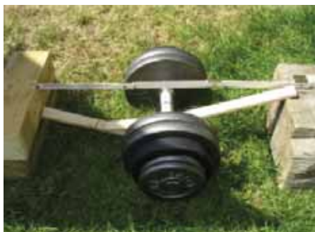
Abb. 2_Holzbrett mit Gewichtsbelastung nach Bruch
